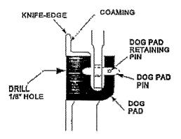
Figure 600-5.11. Removing Dog Pad Pin
