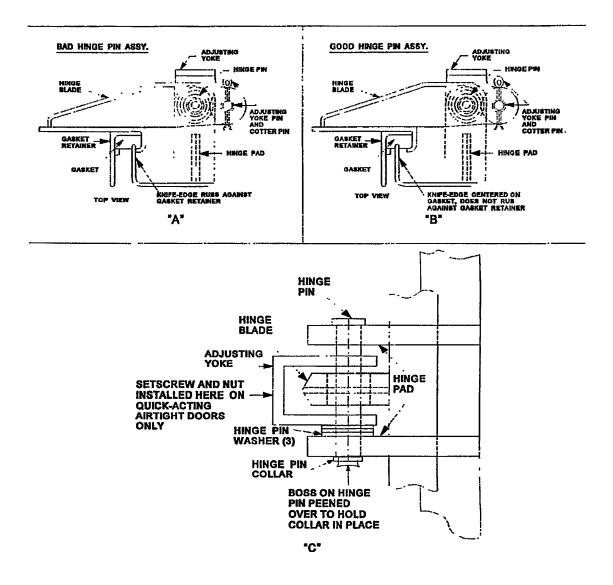
Figure 600-2.9. Hinge Pin Assemblies
