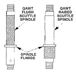
Figure 600-7.8. Scuttle Spindles
