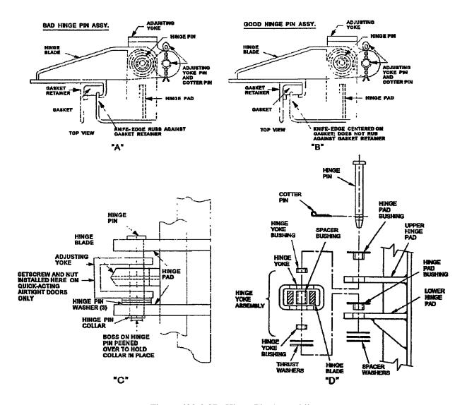
Figure 600-2.27. Hinge Pin Assemblies
