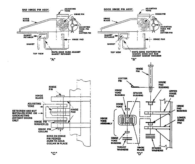
Figure 600-2.5. Hinge Pin Assemblies
