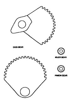
Figure 600-8.4. Scuttle Gears
