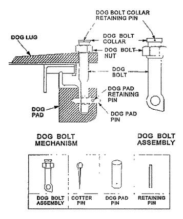
Figure 600-5.10. Watertight Hatch Dog Bolt Mechanism
