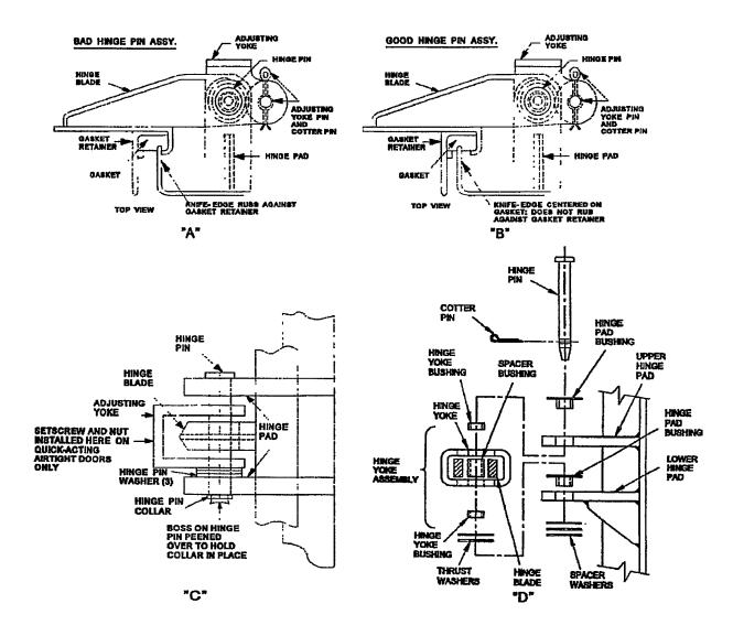
Figure 600-2.21. Hinge Pin Assemblies
