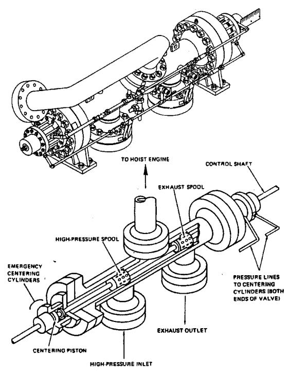
Figure 588-1-8. Main Flow Control Valve
