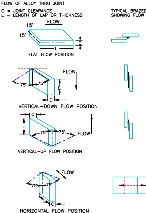
TYPICAL BRAZED JOINTS SHOWING FLOW OF ALLOY
