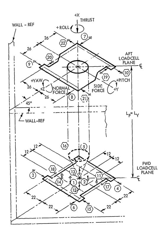
Figure 8-2. <u>Test Stand Schematic</u>
