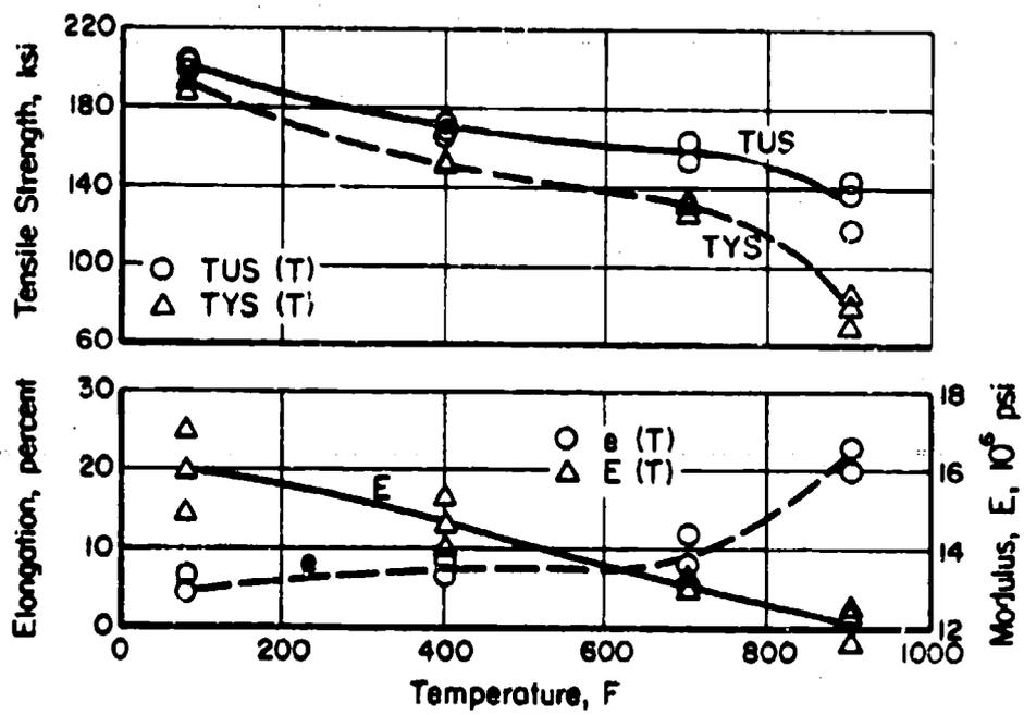
FIGURE 53. EFFECT OF TEMPERATURE ON THE TENSILE PROPERTIES OF SOLUTION TREATED AND AGED T1-6A1-6V-2Sn ISOTHERMAL DIE FORGINGS
