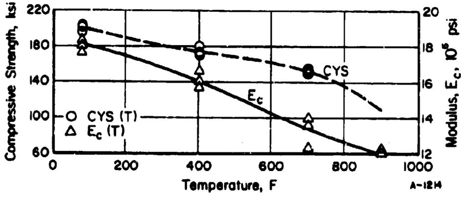
FIGURE 54. EFFECT OF TEMPERATURE ON THE COMPRESSIVE PROPERTIES OF SOLUTION TREATED AND AGED T1-6A1-6V-2Sn ISOTHERMAL DIE FORGINGS
