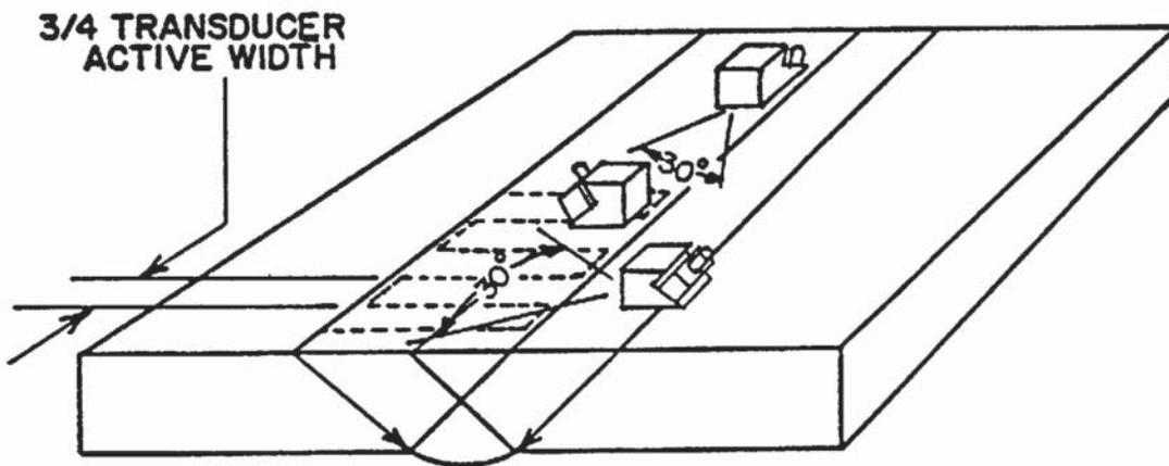
SCANNING PROCEDURES FOR WELDS GROUND FLUSH
