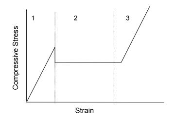
FIGURE 6. IDEALIZED COMPRESSIVE STRESS-STRAIN CURVE FOR HONEYCOMB CORE
