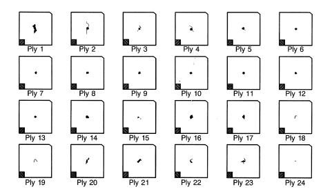
FIGURE 13. TYPICAL PLY-BY-PLY FIBER FAILURE MAP
