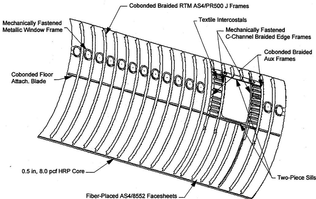
FIGURE 10. THE COMPOSITE SANDWICH CONFIGURATION SIDE PANEL
