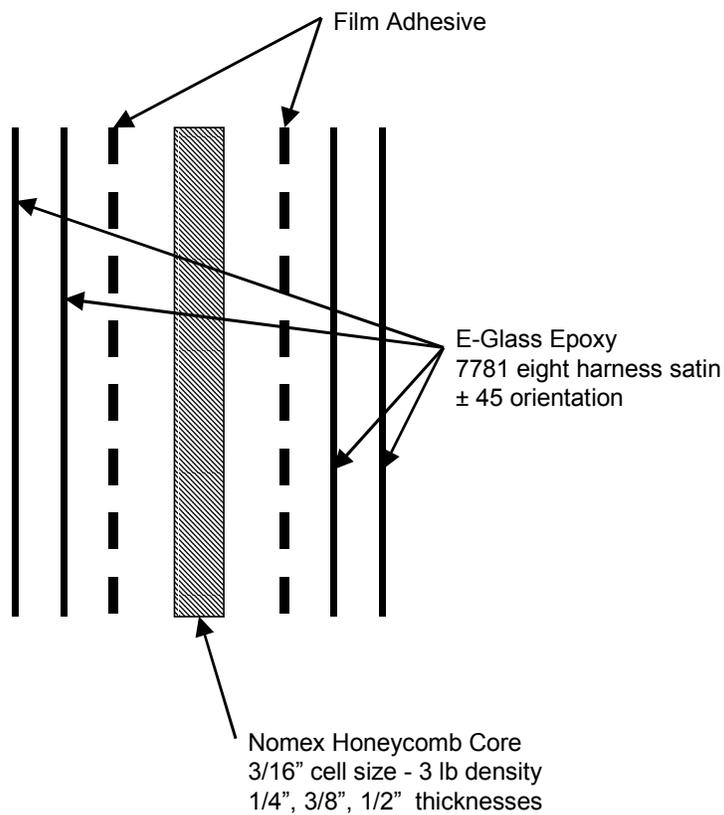
FIGURE 23. TYPICAL LAYUP CONFIGURATION FOR COLUMBIA 300
