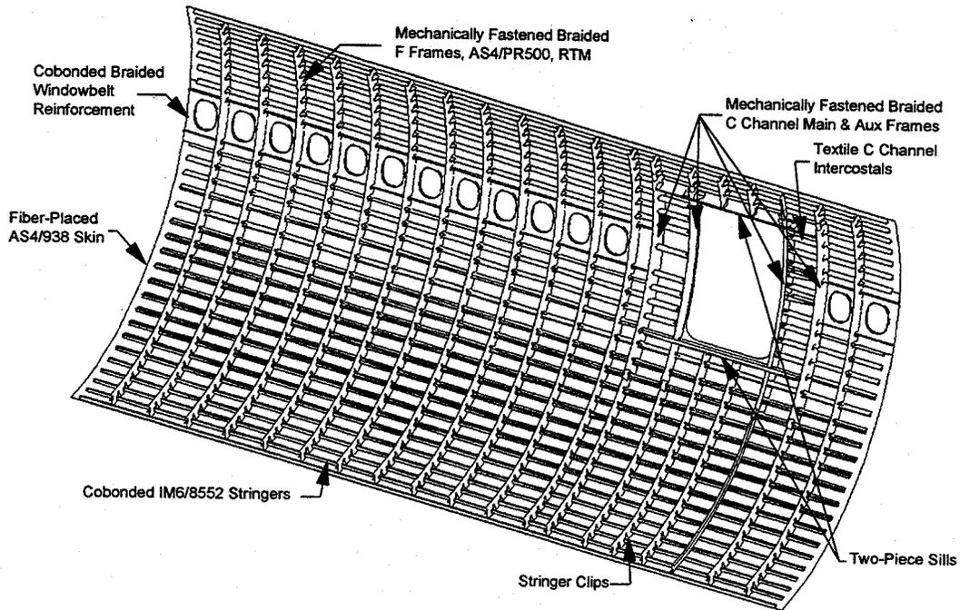
FIGURE 9. THE COMPOSITE SKIN/STRINGER CONFIGURATION SIDE PANEL
