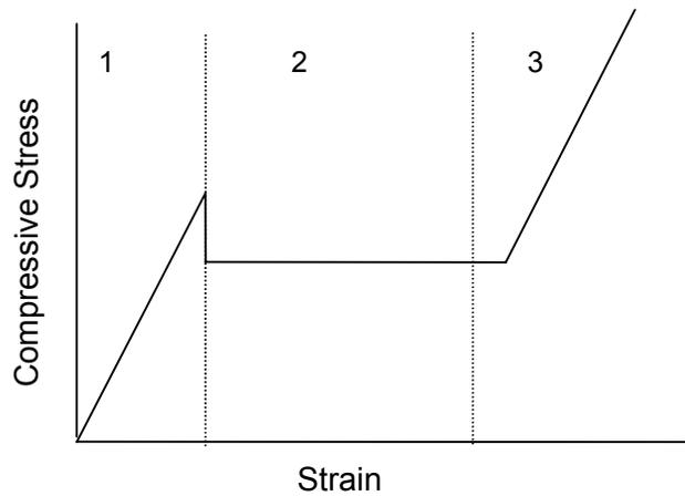
FIGURE 6. IDEALIZED COMPRESSIVE STRESS-STRAIN CURVE FOR HONEYCOMB CORE
