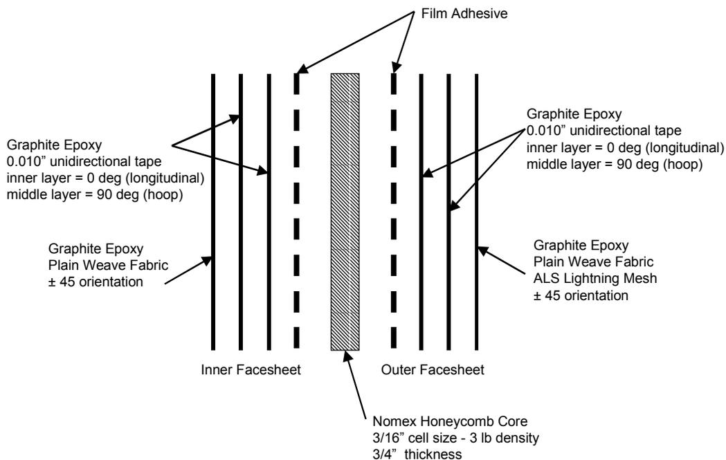
FIGURE 20. TYPICAL LAYUP CONFIGURATION FOR BEECH STARSHIP
