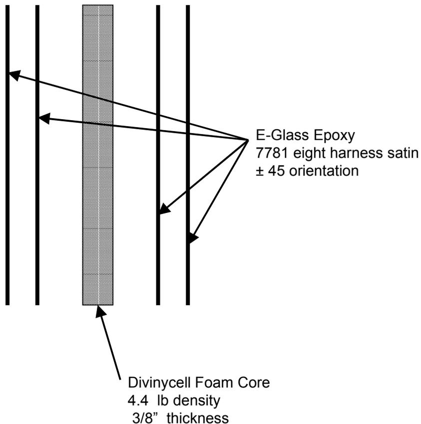
FIGURE 22. TYPICAL LAYUP CONFIGURATION FOR SR20
