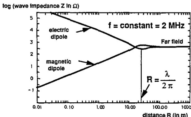
Fig. 2.3.: Wave impedance.
