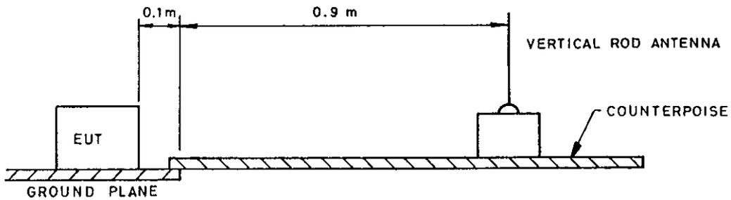
USING A VERTICAL ROD ANTENNA OVER THE
