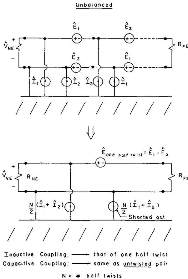
Fig. 21. Untwisting the twisted pair
