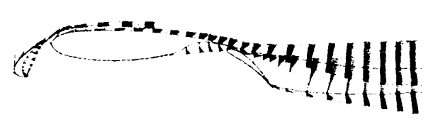
Fig. 21. Non-unicité. Profils de vitesse : Solution A ( M=0.123 , Re=1.8 \cdot 10^6 , \alpha=16^\circ , \delta_{bec}=30^\circ , \delta_{volet}=-40^\circ ).
