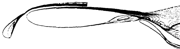
Fig. 28. Non-unicité. Lignes de courant. Solution B ( M=0.123 , Re=1.8 \cdot 10^6 , \alpha=16^\circ , \delta_{bec} = 30^\circ , \delta_{voilet} = -40^\circ ).
