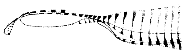
Fig. 20. Non-unicité. Profils de vitesse : Solution B ( M=0.123 , Re=1.8 \cdot 10^6 , \alpha=16^\circ , \delta_{bec}=30^\circ , \delta_{volet}=-40^\circ ).
