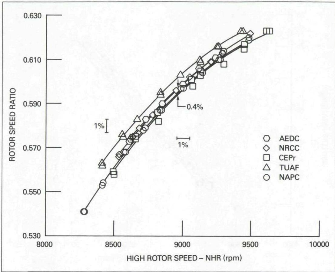
Fig.4 Speed match (engine 615037)
