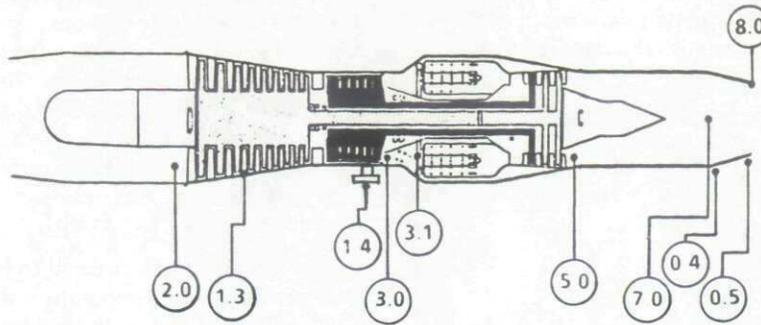
**ENGINE INSTRUMENTATION STATION LOCATIONS**
